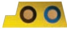
Abb. 3 ASI Kabelquerschnitt links = lange Bezugskante Fig. 3 Cable cross selection left = long reference edge
