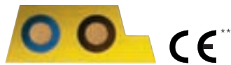
Abb. 3 ASI Kabelquerschnitt rechts = lange Bezugskante Fig. 3 Cable cross section right = long reference edge
