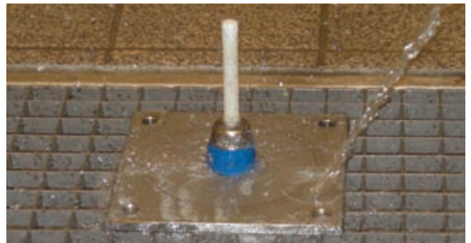
4. Reinigung des Prüfkörpers
